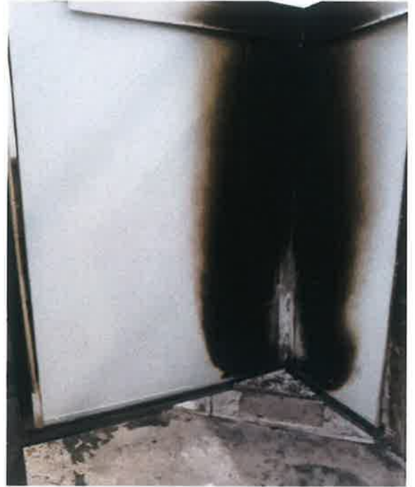
Fotoğraf 8. Numune 1'e ait deney sonrası köşe detayı
