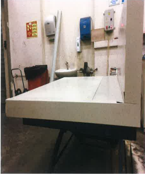
Fotoğraf 1. Numune alt kısmı U profil montajı
