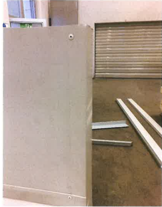
Fotoğraf 2. Numune alt kısmı kısa kanat U profil montajı
