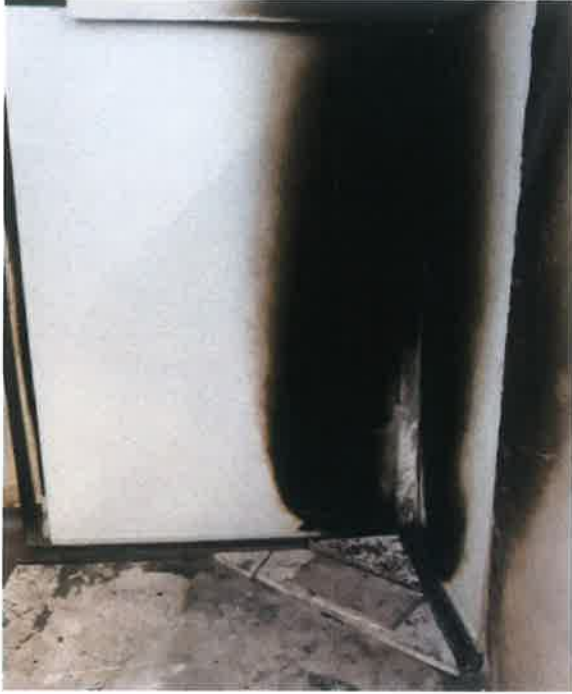
Fotoğraf 7. Numune 1'e ait deney sonrası uzun kanat detayı
